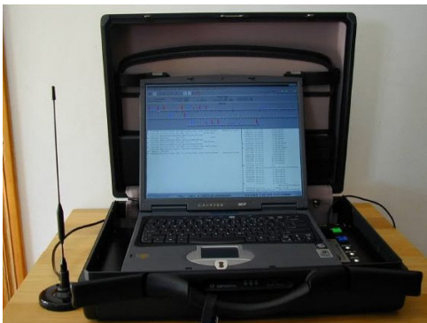
Figur 2 Et eksempel på hvordan en IMSI-catcher ser ut, i form av en laptop med en antenne.
